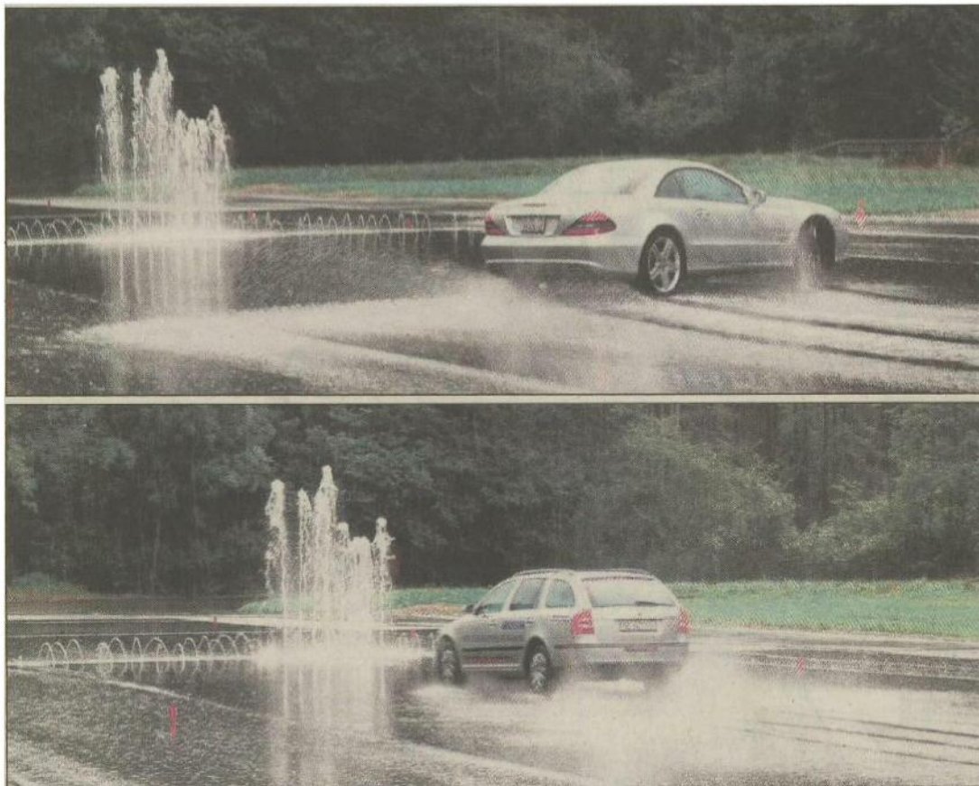
Bei einem Ausweichmanöver bricht das Heck des Wagens (Bild oben) auf nasser Strasse aus. Bilder Fritz Leuzinger Das untere Bild zeigt, wie das Fahrzeug mit dem Fahrassistenten ESP in gleicher Situation der Spur treu bleibt.
